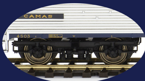
Bogie Minden-Deutz de estructura recta
